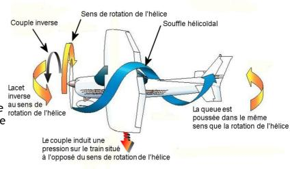
du côté opposé au sens de rotation, se combinant pour créer une action en lacet du coté opposé. Pour contrer cet effet induit et maintenir l'axe de roulage, il est nécessaire de compenser par une action en lacet inverse, palonnier à droite, avec une force proportionnelle à la rapidité de mise en puissance.
